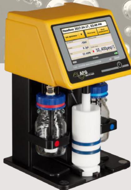
Messung der Partikelladung im Nassbereich der Papier- und Kartonherstellung sowie in jedem wässrigen Ladungssystem mit dem CAS *touch!* Charge Analyzing System. Das Gerät kombiniert einfache, intuitive Bedienung und bewährte Methoden der Messung der Partikelladung mit zusätzlichen Features und einer starken Reduzierung von Größe und Gewicht.
