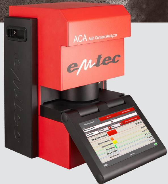
ISO 2144, DIN 54370, TAPPI T 413, 211に沿った製紙業界で従来使用されている燃焼法では、全灰分といくつかのフィラーのみが決定されます。この測定は非常に時間がかかり、人的誤差があり(低い正確性 最大5%)、破壊測定です。サンプルは2設定温度で燃焼され、限られた情報のみしか得られません。
